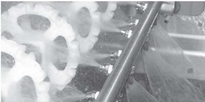
Figura 164: O padrão do spray é projetado para limpeza da parte inferior da esteira, das engrenagens e do eixo
