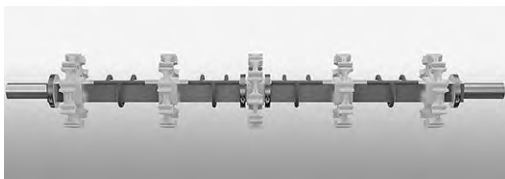
Figura 146: Espaçadores de engrenagem no eixo quadrado com engrenagens e anéis de retenção
